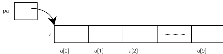
รูปที่ 6.2 แสดงพอยน์เตอร์ชี้ไปยังแอดเดรสเริ่มต้นของตัวแปรชุด
